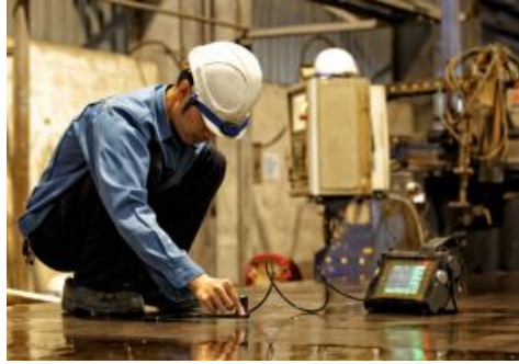
Şekil 14. Tahribatsız muayene işlemi(Non-destructive testing)
