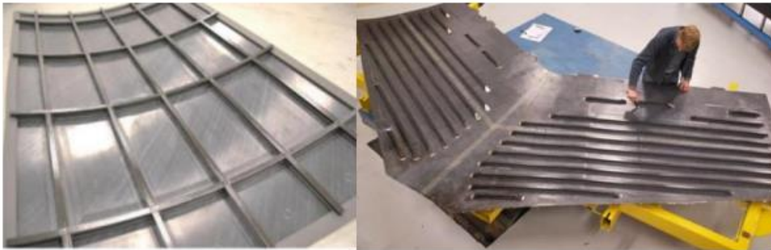
Şekil 4. Üretilen ilk karbon fiber takviyeli PEKK gövde paneli ve PEKK kullanılarak üretilen yatay kuyruk gösterici (van Ingen vd., 2012), (Jeff Sloan, 2018).
