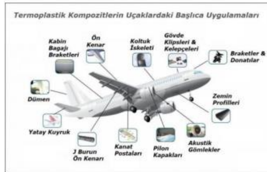
Şekil 1. Termoplastik kompozitlerin uçaklardaki başlıca uygulamaları (Cenk Kurtuluş, 2020).
