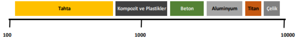
Şekil 2. Bazı malzeme ve kompozitlerin yoğunluk (kg/m 3 ) özellikleri(Density (kg/m 3 ) properties of some materials and composites) (Çobanoğlu, 2017: 197)
