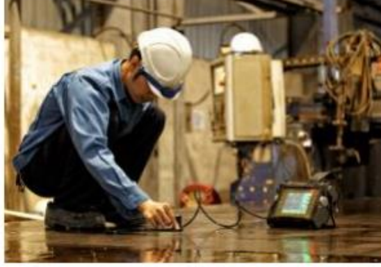
Şekil 14. Tahribatsız muayene işlemi(Non-destructive testing)
