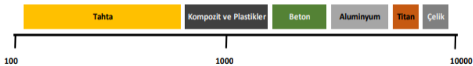
Şekil 2. Bazı malzeme ve kompozitlerin yoğunluk (kg/m 3 ) özellikleri (Density (kg/m 3 ) properties of some materials and composites) (Çobanoğlu, 2017: 197)
