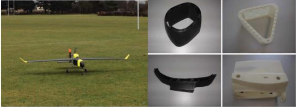
Şekil 7. 3D baskı yöntemi ile üretilen ABS bazlı İHA ve parçaların gösterimi (ebrary.net, -)
