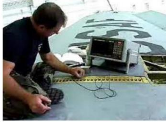
Şekil 26. Ultrasonik test cihazı ile kontrolü(Control with ultrasonic tester)
