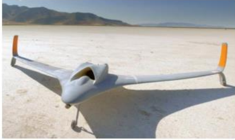
Şekil 3. 3D baskı ile üretilen PEI bazlı İHA (Aaron Pearson, 2020)
