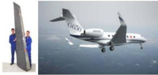
Şekil 2. Gulfstream G650 istikamet dümeni ve jet gösterimi (van Ingen vd., 2010).
